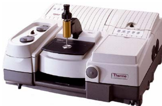
図1 フーリエ変換赤外分光装置 Nicolet 6700 FT-IR + Smart Orbit 1 回反射型 ATR アクセサリ
